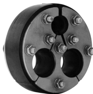
Vatech kabelgennemføring. Delt udførelse. Bredde: 30mm. AISI 304/EPDM Vatech nr. 101762.xxx
