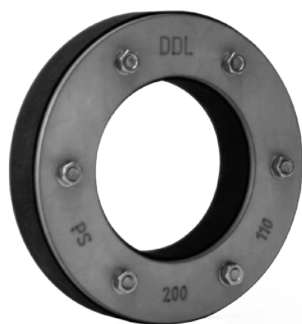
Vatech murgennemføring. Lukket udførelse. Bredde: 30 mm. AISI 304/EPDM Vatech nr. 101750.xxx
