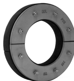
Vatech murgennemføring. Delt udførelse. Bredde: 30 mm. AISI 304/EPDM Vatech nr. 101752.xxx
