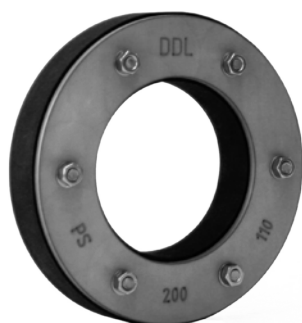
Vatech murgennemføring. Lukket udførelse. Bredde: 30 mm. AISI 316/EPDM Vatech nr. 101754.xxx
