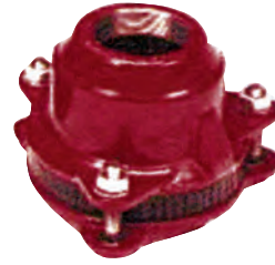
Multijoint 3000. Trækfast gevindkobling. Tætning: EPDM. Syrefaste bolte A4. Vatech nr. 104245.xxx
