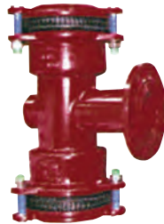
Multijoint 3000. Trækfast tee med flangeafgang. Tætning: EPDM. Syrefaste bolte A4. Vatech nr. 104126.xxx
