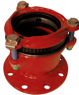
Multijoint 3000. Trækfast flangekobling. Tætning: EPDM. Syrefaste bolte A4. Vatech nr. 104255.xxx
