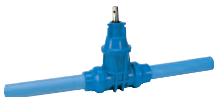
AVK stikledningsventil af POM. Med PE-ender. PN 10. Vatech nr. 142661.0xx
