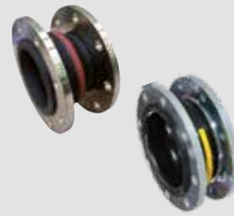
Vatech gummikompensator PN 10. Bælg af EPDM eller NBR. Flange af syrefast stål AISI 316Ti/1.4571 Vatech nr. 435967-68.xxx
