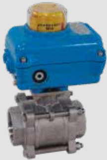
Syrefast 3-delt kuglehane AISI 316. Fuldt gennemløb. Med EI-aktuator 24VDC eller 230VAC. Vatech nr. 418515.xxx
