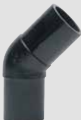
PE-vinkel 45 gr. PE 100. PN 10. For stuk-el svejsning. Vatech nr. 077803.xxx
