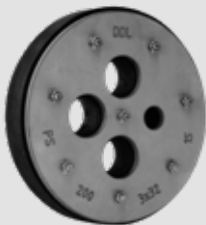
Vatech kabelgennemføring. Lukket udførelse. Bredde: 30mm. AISI 316/EPDM Vatech nr. 101764.xxx
