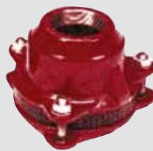
Multijoint 3000. Trækfast gevindkobling. Tætning: EPDM. Syrefaste bolte A4. Vatech nr. 104258,8xx
