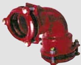
Multijoint 3000. Trækfast bøjning 90 gr. Tætning: EPDM. Syrefaste bolte A4. Vatech nr. 104265.xxx
