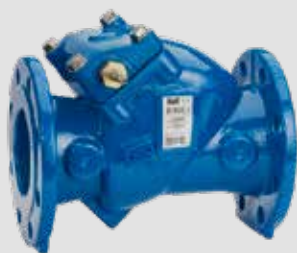
AVK kontraklapventil. Med fri akselende i højre side. Epoxybehandlet. PN 10 Vatech nr. 431065.0xx
