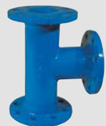
Stbj. flangetee. Reduceret. Epoxybehandlet. PN 10. Vatech nr. 131130.xx1
