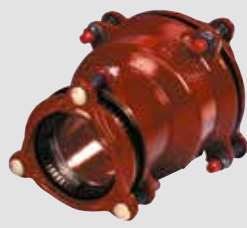
Multijoint 3000. Trækfast reduceret rørkobling. Tætning: EPDM. Syrefaste bolte A4. Vatech nr. 104252.xxx
