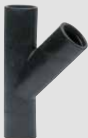
PE-Teel 45 gr. PE 100. PN 10. For stuk-el svejsning. Vatech nr. 077749.xxx
