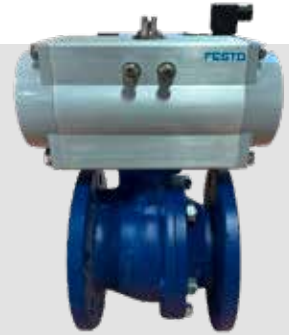
Kuglehane med flanger. Fuldt gennemløb. Hus af epoxybehandlet støbejern. Kugle af rustfrit stål AISI 316. Spindel af rustfrit stål AISI 304. Tætning af NBR. Med Festo pneumatisk aktuator. Enkeltvirkende/dobbeltvirkende. Vatech nr. 418434.0xx
