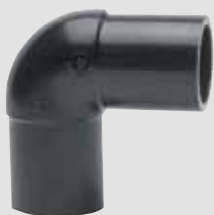
PE-vinkel 90 gr. PE 100. PN 10. For stuk-el svejsning. Vatech nr. 077801.xxx
