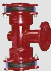
Multijoint 3000. Trækfast tee med flangeafgang. Tætning: EPDM. Syrefaste bolte A4. Vatech nr. 104126.xxx
