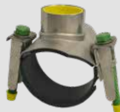
AVK Universal anboringsbøjle. PN 10. Rustfrit stål AISI 304. Tætning: NBR. Vatech nr. 101326.xxx
