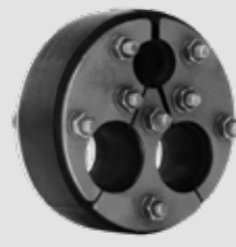
Vatech kabelgennemføring. Delt udførelse. Bredde: 30mm. AISI 304/EPDM Vatech nr. 101762.xxx
