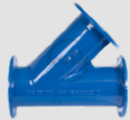
Stbj. flange-T. 45 gr. Epoxybehandlet. PN 10. Vatech nr. 131131.xxx
