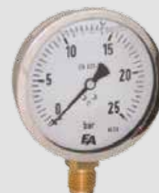
Glycerinfyldt manometer Ø 63 mm. Hus af rustfrit stål AISI 304. 1/4" tilslutning af messing. Nedad eller bagud. Vatech nr. 481150.0xx
