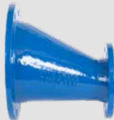
Stbj. flangereduktion. Excentrisk. Epoxybehandlet. PN 10 Vatech nr. 131167.xxx
