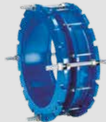
Vatech ekspansionsstykke serie 265/30 Hus af epoxybehandlet stål. Forskydelig: +/- 60 mm. Tætning af EPDM. Max. Arbejdstryk: 25 bar. Vatech nr. 141901.xxx
