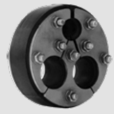
Vatech kabelgennemføring. Delt udførelse. Bredde: 60mm. AISI 304/EPDM Vatech nr. 101763.xxx
