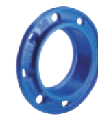
Serie 05 Combi-flange til uPVC-, stål- eller duktiljernsrør Ikke-trækfast Duktiljern DN400-600 (uPVC og duktiljern) DN50-300 (stål) PN10/16
