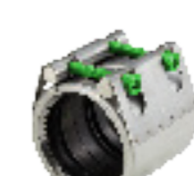
Serie 745/01 Repico Grip kobling Universal og trækfast for alle metalrør Rustfrit stål AISI 316 NBR eller EPDM DN15-400
