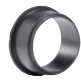
Serie 05 Combi-flange pakning til uPVC-, stål- eller duktiljernsrør Ikke-trækfast SBR gummi DN400-600 (uPVC og duktiljern) DN50-300 (stål)
