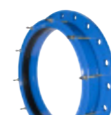
Serie 260 Opsvejst flangeadapter til AC-, stål-, gråjerns- eller duktiljernsrør Blødt stål DN350-2000 PN10/16/25
