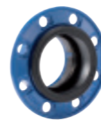
Serie 05 Combi-flange til PE- og PVC-rør Trækfast Duktiljern/EPDM DN50-300 PN10/16
