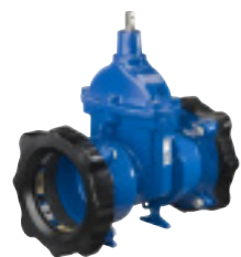
Serie 636 Supa Maxi™ ventil Universal og trækfast til alle rørtyper Duktiljern DN80-300 PN16
