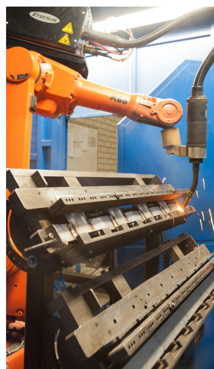
Ovenfor: Rewag-fabrik hos AVK Nederland BV, hvor REPICO® fremstilles. Til højre: Robotsvejsning på Rewag-fabrikken.
