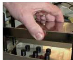
Gummiet deformeres med 25 % ved kompressionstesten
