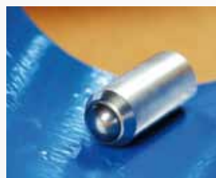
Slagstyrken kontrolleres ved hjælp af en stålcylander
