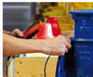
Epoxy lagtykkelsen skal være min. 250 \mu på alle flader
