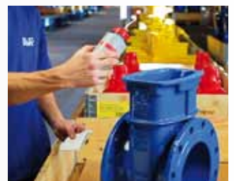
I MIB testen må der ikke være farveafsmitning
