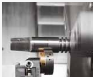
Spindler til gasventiler (3) poleres for at sikre fuld tæthed
