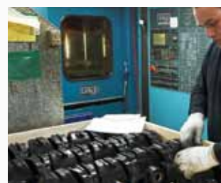
Skyderne vulkaniseres med min. 4 mm på alle tætningsoverflader
