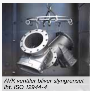
Epoxybelægning iht. DIN 30677-2 og GSK retningslinjer
