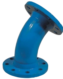
Stbj. flangebøjning 45 gr. Epoxybehandlet. PN 10. Vatech nr. 131104.xxx
