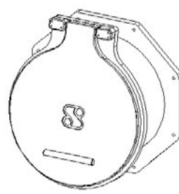
Vatech HDPE udløbsklap. Afvinkling 10°. Tilslutning: Vægflange. Type TKV-A. Vatech nr. 226000.3xx
