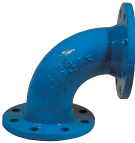
Stbj. flangebøjning 90 gr. Epoxybehandlet. PN 10. Vatech nr. 131100.xxx
