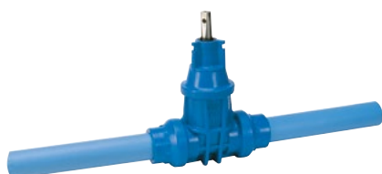
AVK stikledningsventil af POM. Med PE-ender. PN 10. Vatech nr. 142852.0xx
