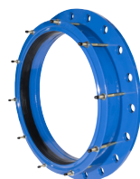
Serie 260 Opsvejst flangeadapter til AC-, stål-, gråjerns- eller duktiljernsrør Blødt stål DN 350-2000 PN 10/16/25
