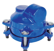
Serie 624/10 Supa Plus™ slutmuffe Trækfast til PE- og uPVC-rør Duktiljern DN 40-300 PN 16
