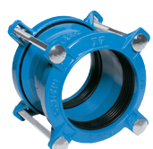
Serie 601 Supa® lige kobling Universal til uPVC-, AC-, stål-, gråjerns- og duktiljernsrør Duktiljern DN 40-400 PN 16
