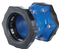
Serie 631 Supa Maxi™ lige kobling Universal og trækfast til alle rørtyper Duktiljern DN 50-400 PN 16
