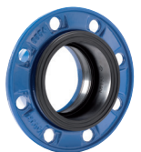
Serie 05 Combi-flange til PVC-rør Ikke trækfast Duktiljern/EPDM DN 50-300 PN 10/16
