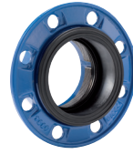
Serie 05 Combi-flange til PE- og PVC-rør Trækfast Duktiljern/EPDM DN 50-300 PN 10/16
