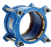
Serie 621/10 Supa Plus™ lige kobling Trækfast til PE- og uPVC-rør Duktiljern DN 32-300 PN 16
