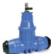
Serie 16/54 Stikledningventil med trækfaste indstiksmuffer til PE-rør PN 16 POM (Polyoxymethylen) DN 25-50
