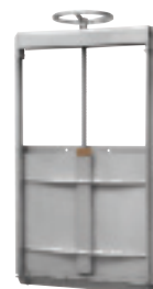
Serie 772/61 Vægmonteret skydespjæld Gennemstrømning fra begge sider til og med 1200 X 1200 mm, i større størrelser fra én eller begge sider Med ikke-stigende spindel Rustfrit stål AISI 304 200 x 200 mm - 2000 x 2000 mm
