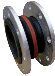
Vatech gummikompensator PN 10. Bælg af EPDM eller NBR. Flange af rustfrit stål AISI 304 eller syrefast stål AISI 316 Vatech nr. 435957.xxx
