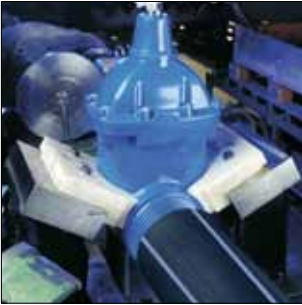
PE-røret presses på ventilen.
