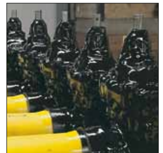
Som en yderligere beskyttelse kan ventilerne coates med polyurethan (PUR) i henhold til DIN 30671.
