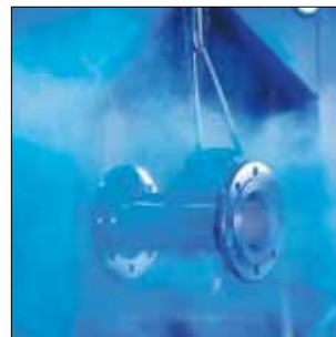
Elektrostatisk påført epoxybelægning i henhold til DIN 30677.
