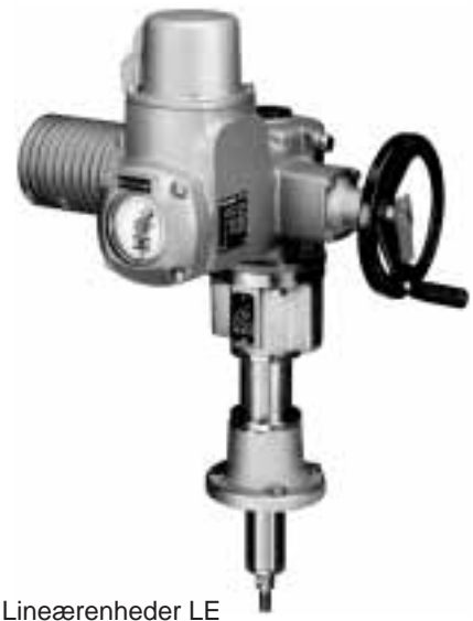
Styring AUMA Matic med EI-drev SA/ SAR Drejningsmoment fra 10 til 1 000 Nm Omdrejningstal fra 4 til 180 min -1
