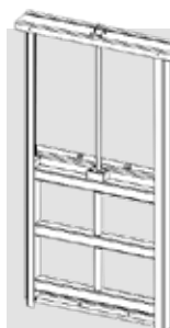
Vatech HDPE skydespjæld. For montage i kanal. Med 1 spindel. Vatech nr. 228003.0xx
