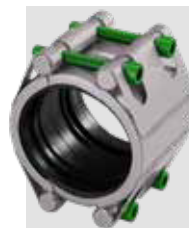
AVK Repico® reparationskobling type RSD. Med 2 spændebeslag. Hus og beslag af syrefast stål AISI 316. EPDM-tætning. Vatech nr. 101312.xxx
