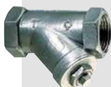
Snavssamler med gevind. Syrefast stål AISI 316. Si af rustfrit AISI 304. Vatech nr. 449129.0xx
