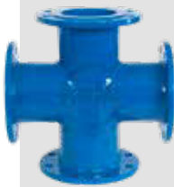
Flange-kryds. Epoxybehandlet støbejern. PN10. Vatech nr. 131133.xxx
