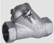
AVK kuglekontraventil. Med gevind. NBR gummibelagt kugle. Syrefast rustfrit stål AISI 316. PN10. Vatech nr. 430855.0xx
