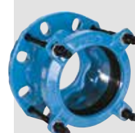
AVK Supa® flangekobling. Ikke-trækfast. A2 bolte. A4 møtrikker. DN40-400 mm. Vatech nr. 142002.xxx
