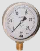
Glycerinfyldt manometer Ø 63 mm. Hus af rustfrit stål AISI 304. ¼" tilslutning af messing. Nedad eller bagud. Vatech nr. 481150.0xx
