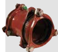
Multijoint 3000. Trækfast rørkobling. Tætning: EPDM. Syrefaste bolte A4. Vatech nr. 104251.xxx
