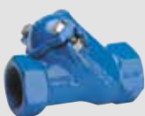
AVK kuglekontraventil. Med gevind. NBR gummibelagt kugle. Epoxybehandlet. PN10. Vatech nr. 430854.0xx
