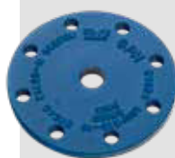
Blindflange. Med gevind. Epoxybehandlet støbejern. PN10. Vatech nr. 131171.xxx
