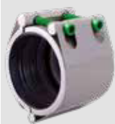
AVK Repico® reparationskobling type RH. Hængslet udførelse. Hus og beslag af syrefast stål AISI 316. EPDM-tætning. Vatech nr. 101310.xxx
