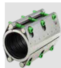
AVK Repico® reparationskobling type RSDL. Lang model. Med 2 spændebeslag. Hus og beslag af syrefast stål AISI 316. EPDM-tætning. Vatech nr. 101313.xxx
