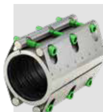
AVK Repico® reparationskobling type RSDL. Lang Model. For højt arbejdstryk. Hus og beslag af syrefast stål AISI 316. EPDM-tætning. Vatech nr. 101314.xxx
