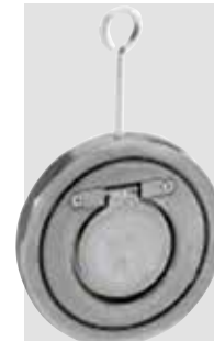
Sandwich kontraklapventil. For indspænding mellem flanger. Hus af syrefast stål AISI 316. Vatech nr. 431368.0xx
