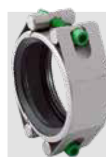
AVK Repico® reparationskobling type RE. For montering på bøjninger. Hus og beslag af syrefast stål AISI 316. EPDM-tætning. Vatech nr. 101315.xxx
