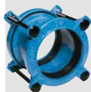
AVK Supa® rørkobling. Ikke-trækfast. A2 bolte. A4 møtrikker. DN40-400 mm. Vatech nr. 142000.xxx
