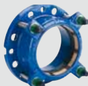
Serie 621/10 Supa Plus™ lige kobling Trækfast til PE- og uPVC-rør DN 32-300 Duktiljern PN 16
