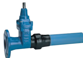
AVK skydeventil med PE-ende og flange. PE-100. PN 10.
