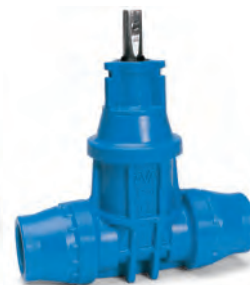
AVK stikledningsventil af POM med indstiksmuffer for PE-rør. PN 10. Vatech nr. 144818.0xx
