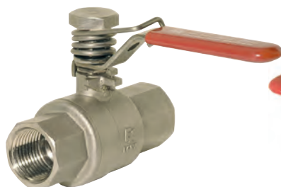
Syrefast 2-delt kuglehane AISI 316. Med håndtag og fjeder retur. Fuldt gennemløb. Vatech nr. 418009.0xx
