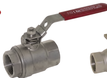
Syrefast 2-delt kuglehane AISI 316. Med håndtag og låseanordning. Fuldt gennemløb. Vatech nr. 418000.0xx
