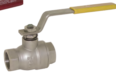
Syrefast 2-delt kuglehane AISI 316. Med håndtag og låseanordning. Op til 2" DVGW-godkendt til gas. (Max. 5 bar) Fuldt gennemløb. Vatech nr. 418237.0xx
